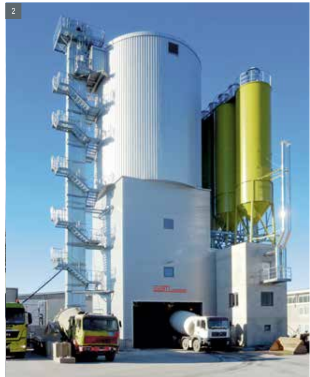
1. Vorsatzmischanlage / Face concrete mixing plant ■ 2. TOWERMIX® 3000 + 1500 ST D10 – Produktion von Stahlbetonfertigteilen / Production of reinforced concrete elements
