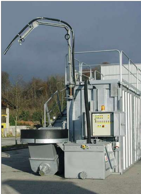
Abb. 1 Restbetonaufbereitung in Containerausführung Typ RBR
