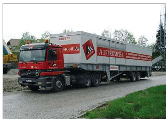
Abb. 4 Transport EUROMIX 2000 mit isolierter Verkleidung
