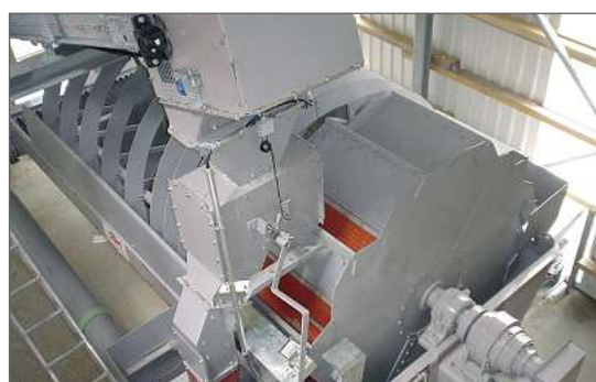
Abb. 3 Sandfänge zum Entwässern und zur Sandkorrektur
