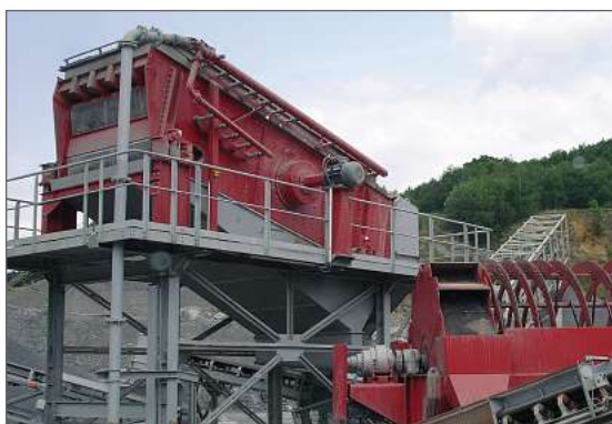
Abb. 2 Kreisschwingsieb mit Bebrausung
