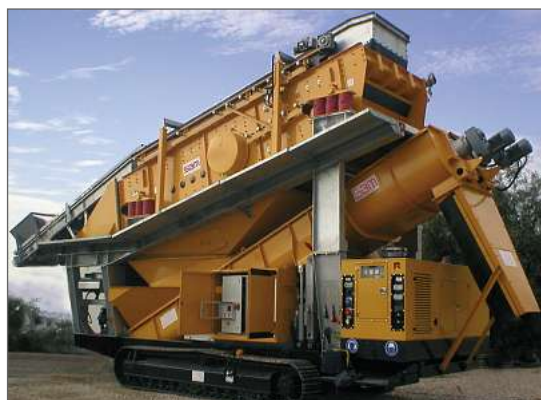
Abb. 2 Entwässerungsschnecken zur Sandentwässerung
