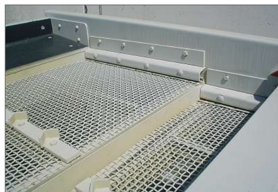
Abb. 4 Querspannmatte in Stahl mit Befestigungselementen
