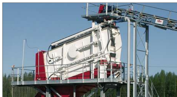
Abb. 2 Kreisschwingsieb mit Bebrausung
