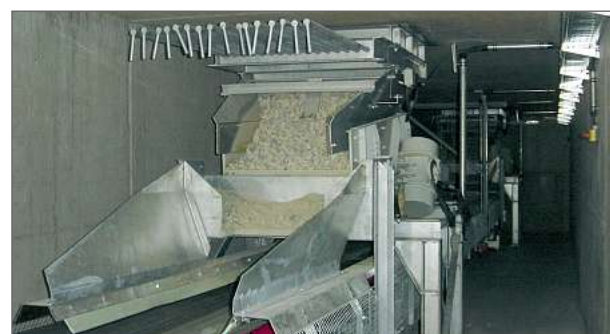
Abb. 4 Tunnelabzug: Vibrationsrinne mit Nadelschieber
