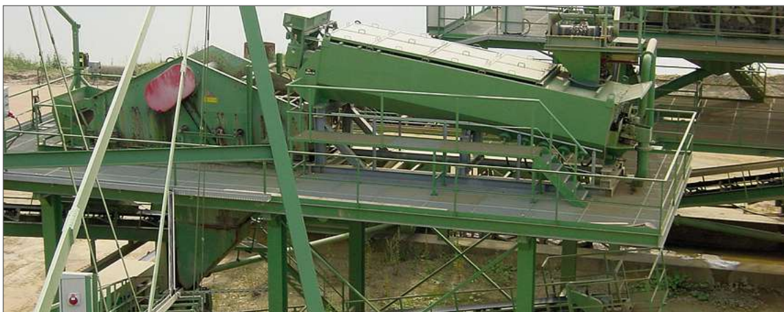
SBM bietet Maschinen und Geräte für sämtliche Verfahrensschritte, z. B. Abb. 1 Schwertwäschen zur Materialreinigung
