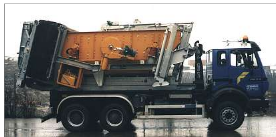
Abb. 3 Containermobiles Sieb CM 14/38-1, kompakt, mobil und schnell transportierbar
