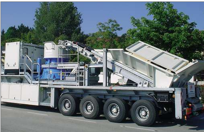
Abb. 2 Radmobiler Kegelbrecher H4800 beim Transport
