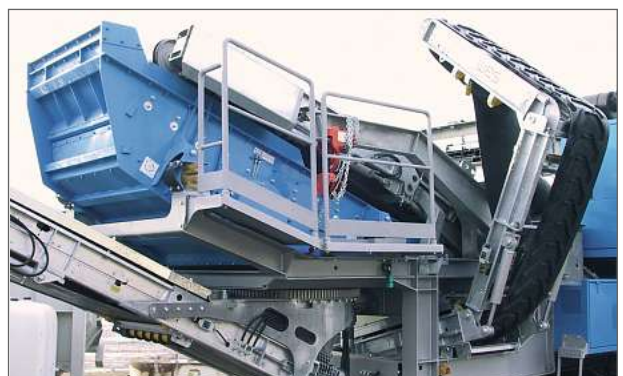
Abb. 3 Standard: Schwenkband mit Drehzahnkranz und verzinkte Rahmenkonstruktion
