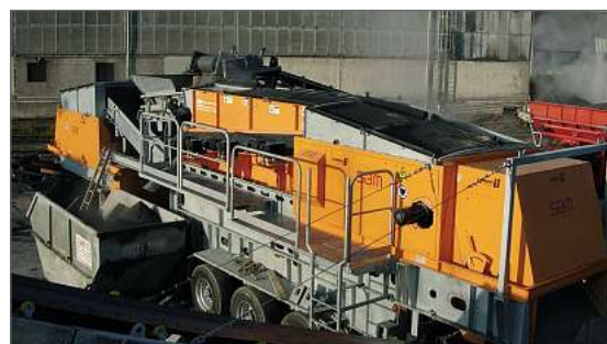
Abb. 4 SBM-Vielfalt in den Anwendungen: Mobile Anlage zur Abscheidung von Nichteisen-Metallen
