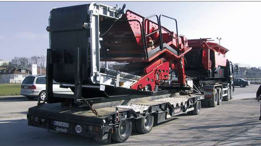
Abb. 1 remax 1318 E/D SII, Transport des Siebmoduls und der Aufgabeeinheit
