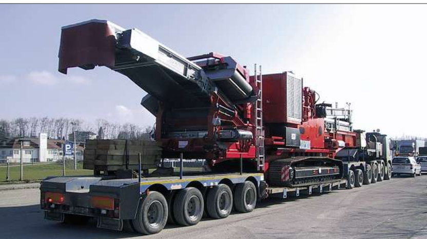
Abb. 2 remax 1318 E/D SII Transport der Brechereinheit
