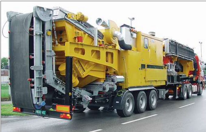
Abb. 1 Kompakt und 80 km/h schnell: Radmobiler Multipactor V20; intelligente Faltechnik der Förderbänder spart Transportkosten
