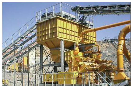
Abb. 4 Kalkstein-Nachbrechanlage mit 2 Prallbrechern 13/21/4 RHSMK5 für 1000 t/h, Aufgabe bis 300 mm, Endprodukt 0/20 mm
