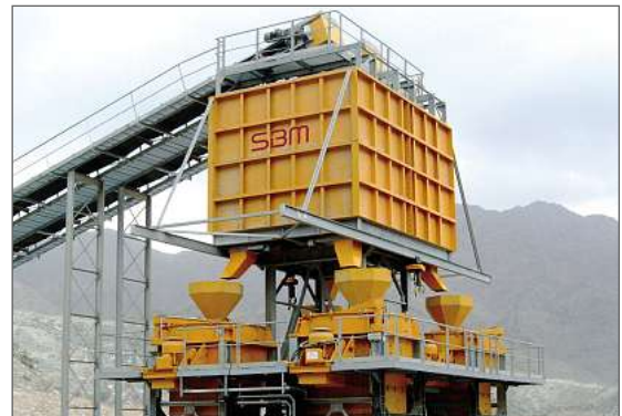
Abb. 2 4 Vertikal-Prallbrecher zur Kornformverbesserung nach Kegelbrechern, Material Gabbro, Leistung 700 t/h
