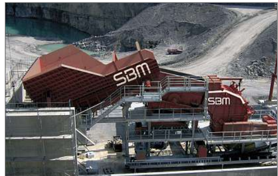
Abb. 2 Vorbrechanlage für Muschelkalk mit Plattenband PA 14/11 und Prallbrecher 16/19/6 SH
