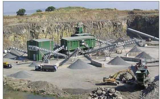
Abb. 4 Basaltsteinbruch mit mobiler Vorbrechanlage, Leistung 500 t/h, Typ remax, 2 mobcon Bändern 1200 x 38 m, stationäre Aufbereitung mit Prallbrechern 13/21/3 RHSMK3 und V22
