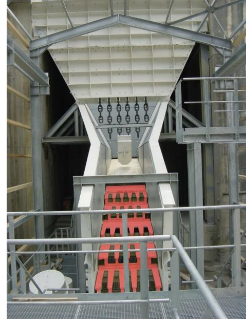
Bypass-Abscheidung zur Entlastung des Brechprozesses
