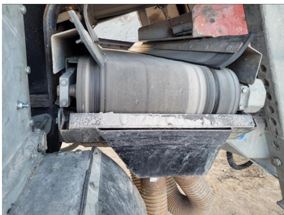
Überkornband mit Windsichter Oversize belt conveyor with windsifter
